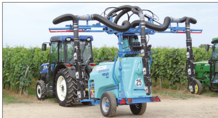
Certains pulvérisateurs en face par face pour les vignes sont également autorisés pour réduire les ZNT. Il est important de bien identifier les modèles autorisés. Ces pulvérisateurs en face par face permettent d'améliorer le débit de chantier par rapport aux panneaux récupérateurs limitant souvent le travail à 2 rangs. (Crédit photo FDCUMA - Raphaëlle Poissonnet)
