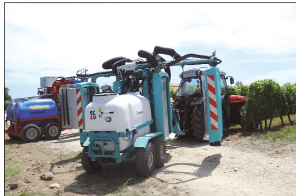
Dans les vignes, plusieurs marques de pulvérisateurs avec panneaux récupérateurs sont autorisées pour réduire les zones non traitées de 20 à 5 m ou de 50 à 5 m. (Crédit photo FDCUMA Raphaëlle Poissonnet)
