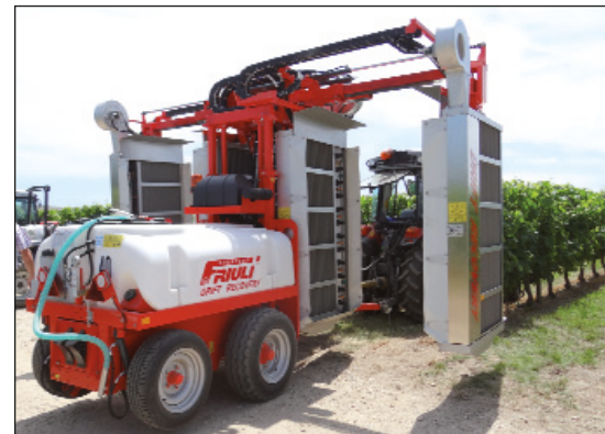
Dans les vignes, plusieurs marques de pulvérisateurs avec panneaux récupérateurs sont autorisées pour réduire les zones non traitées de 20 à 5 m ou de 50 à 5 m. (Crédit photo FDCUMA Raphaëlle Poissonnet)
