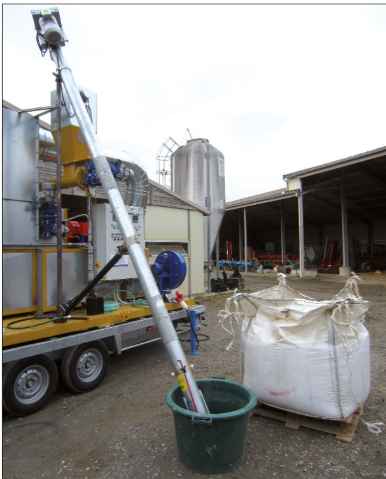
Le toasteur est mobile et doit être déplacé avec un véhicule routier possédant un PTR (poids total roulant autorisé) de 7 tonnes minimum. Le permis BE est nécessaire. (Photo FD Cuma du Gers)
