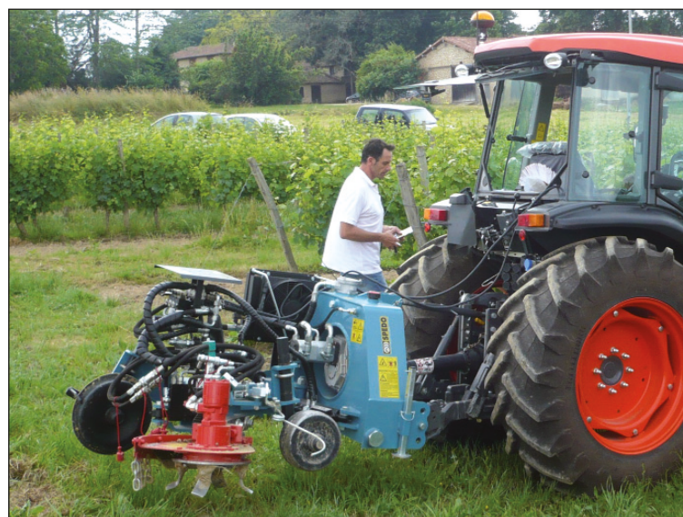
Tête de désherbage rotative entraînée par centrale hydraulique (société Spedo)
