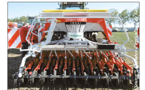
Un semoir mixte, en ligne et monograinne
