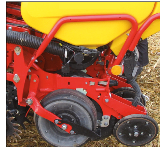
La distribution est entraînée par un moteur électrique
