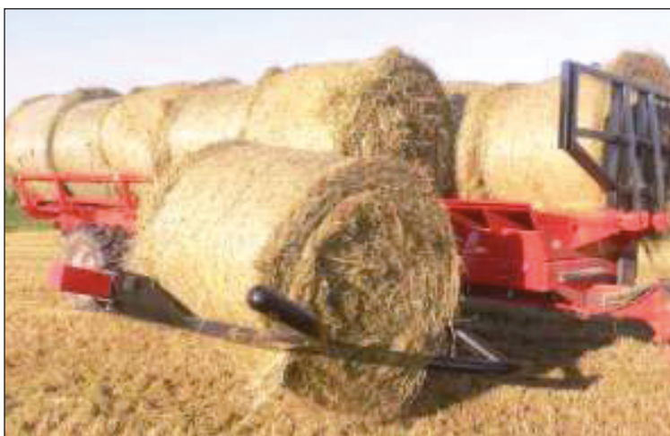
Chargement latéral et autonome des bottes rondes (Source image : CGAO24)
