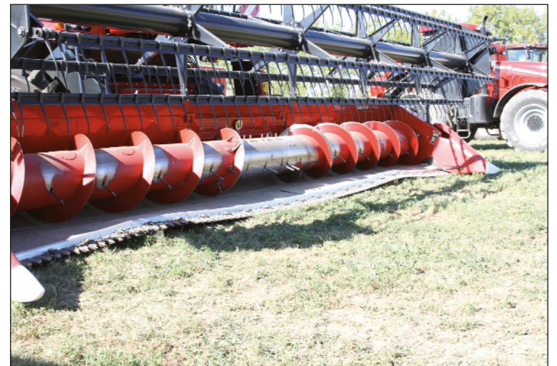
Coupe de la CUMA lors d'InnovAgri 2013. Notez l'ondulation de la coupe pour suivre le relief. (Source : S. Pavan)
