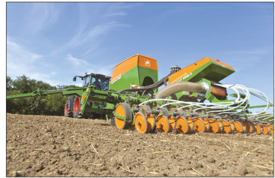
Semoir monograine Amazone EDX avec cuve de fertilisation à l'avant.
