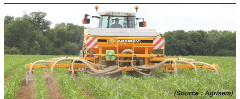
Figure 6 : Localisateur d'engrais solides avec enfouissement et système de binage associé
