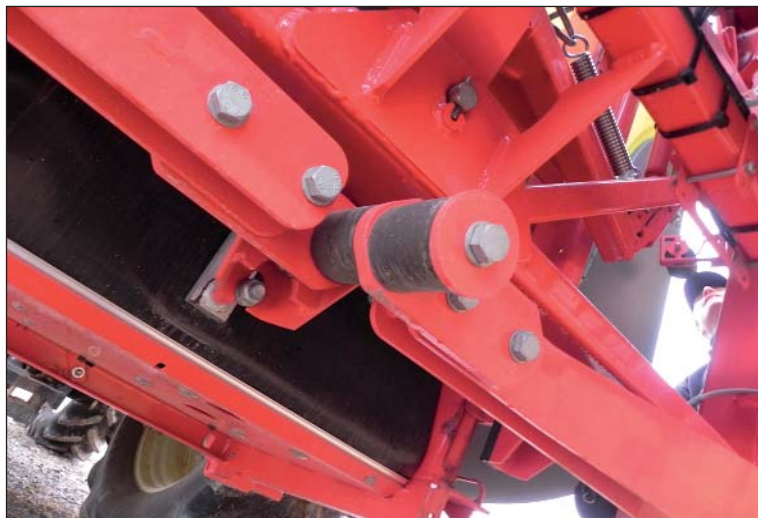
Afin d'éviter les phénomènes de fouettement, les constructeurs optent pour une suspension sillent-bloc en élastomère ou via une suspension hydro-pneumatique.
