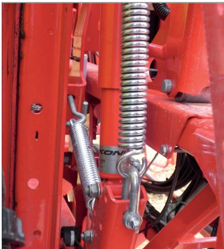
La suspension latérale mécanique est indispensable sur des largeurs de rampe de plus de 21 m.
