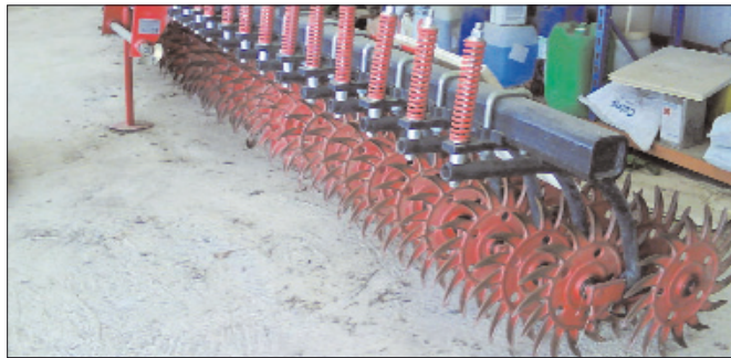
Les étoiles qui composent la houe rotative sont en fonte ou en acier et il est possible de faire un montage inversé pour éviter l'arrachage de la culture.
