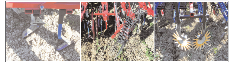
Les doigts en caoutchouc pour un désherbage sur la ligne sont efficaces sur adventices au stade plantule et leur réglage ne doit pas engendrer un arrachage de la culture. Il est possible de monter une herse peigne sur la ligne de semis pour parfaire le binage et il est disponible rotatif pour augmenter l'agressivité sur la ligne.
