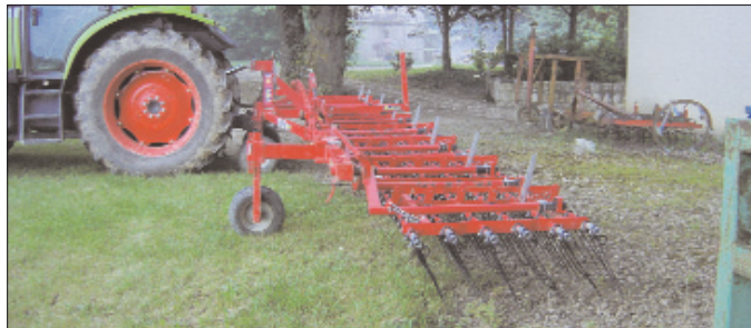
Le réglage hydraulique de la tension des dents est différent d'une marque à l'autre. Le principe de réglage avec câbles indépendants permet un pianotage de l'outil et donc un suivi parfait du sol en condition mottée.
