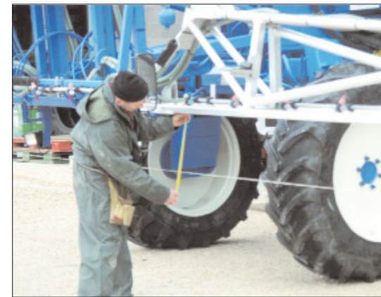
Vérification de la rectitude de la rampe : rampe courbée ou déformée
