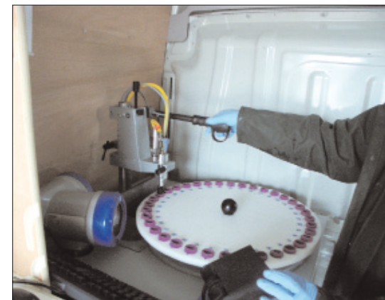
Contrôle du débit des buses : débit des buses au delà des tolérances admises
