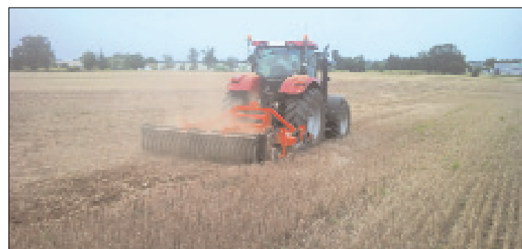
Le principal atout de cet outil est son débit de chantier qui est plus important qu'un déchaumeurs à socs ou un pulvérisateur à trains de disques. Les DDI sont souvent associés à un rouleau qui est dans la plupart des cas prévus pour le contrôle de la profondeur. La durée de vie des disques est légèrement inférieure à ceux des cover crop car la vitesse d'avancement est plus rapide, et l'entretien de cet outil peut être élevé en fonction de la durée de vie des roulements et de leurs disposition dans les moyeux. Le montages de roulement à rouleaux coniques permet de subir des efforts transversaux et latéraux.
