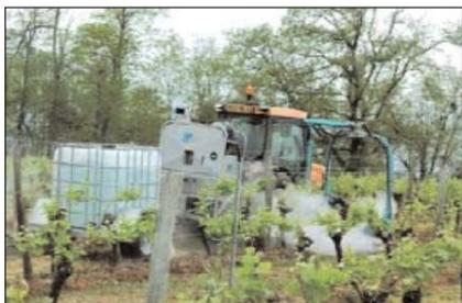
De l'eau transportée dans une remorque, chauffée grâce à une génératrice sur prise de force, pressurisée puis envoyée de chaque côté du rang de ceps, grâce à un portique d'épandage. 6 buses spéciales l'amènent à 100° au niveau du sol. Ce procédé a été mis au point par une société située dans les Pyrénées Atlantiques spécialisée dans la haute pression. Investissement : entre 15 et 22 000 euros suivant l'équipement (l'eau peut aussi se transporter dans
