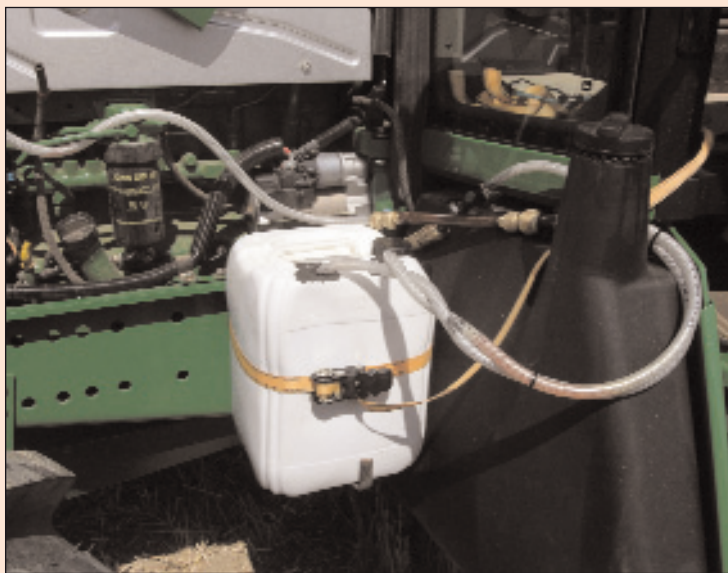
Pour mesurer la consommation : un réservoir amovible et une pesée avant-après.
