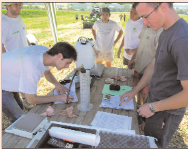
Pour mesurer la consommation : un réservoir amovible et une pesée avant-après.
