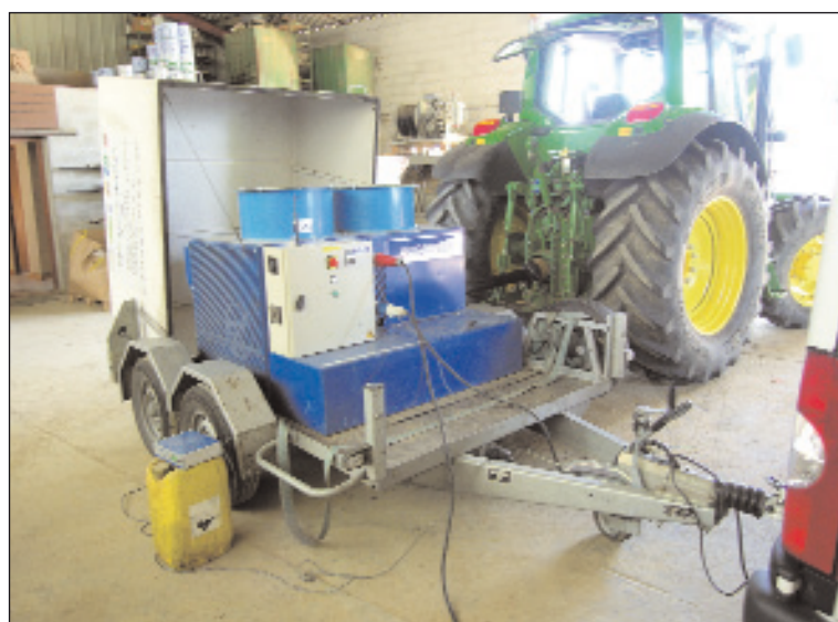
Le passage au banc moteur, préalable pour déterminer le régime "économique".
