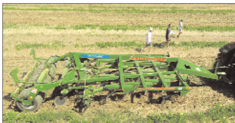
Pour une bonne maîtrise des conditions d'essai, c'est un outil traîné qui a été choisi, un Amazone Centaur.
