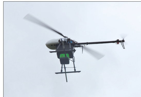
Le drone équipé de l'épandeur à trichogrammes peut traiter 20 ha en un seul vol de moins de 30 minutes ! (Photo Défense Paysanne)
