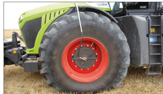
Monte de pneu permettant de bien réduire la pression.
