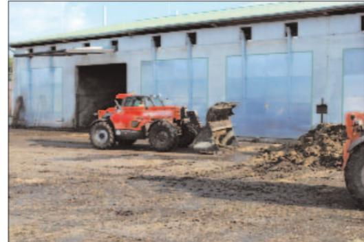
Remplissage d'un digesteur d'une installation de méthanisation par voie sèche discontinue de type BEKON à Melzingen dans le nord de l'Allemagne. (source BEKON)
