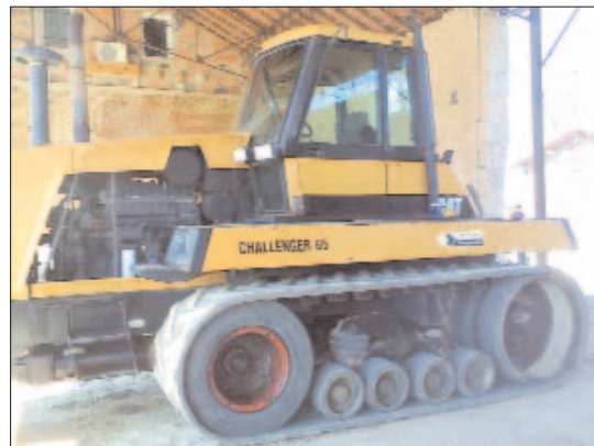
Tracteur équipé pour limiter le tassement
