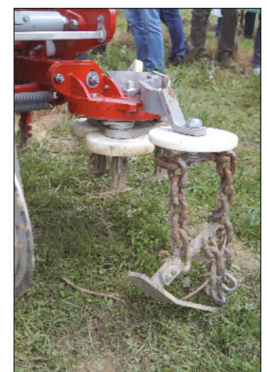
Pour des adventices peu développées, la bineuse Ecosatylt de Léger présente un fonctionnement original. (Photo Nicholas Macnair)
