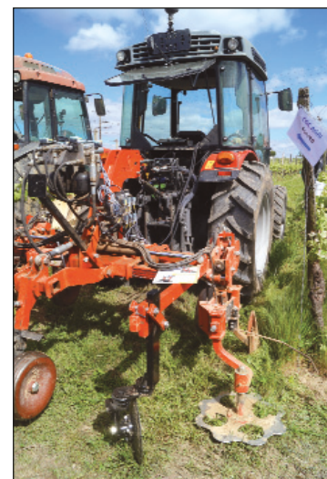
L'Ecocep de CGC Agri passe au plus près des ceps grâce à sa forme originale. (Photo Nicholas Macnair)
