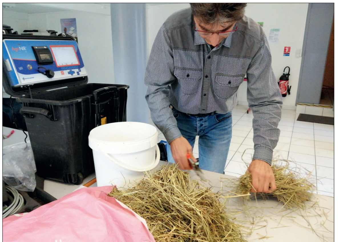
L'analyseur portable Agri-NIR (technique infra-rouge) permet de réaliser sur place l'analyse de nombreux types de fourrages, avec un résultat immédiat. Pour plus de fiabilité, 2 à 3 mesures sont réalisées pour un même échantillon.
