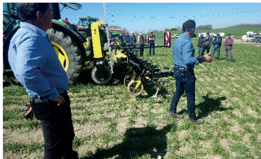
Le matériel français Phoenix : bineuse et interface imposante de conception récente-2017-bineuse autoguidée grâce à une caméra colorimétrique placée latéralement, qui lit en continu trois rangs de blé.
