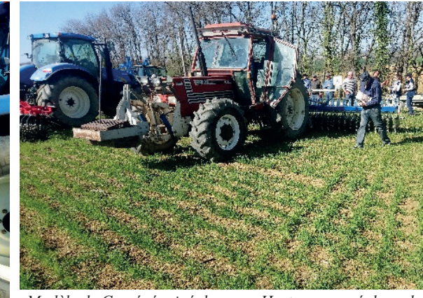
Modèle de Carré, équipé de roues Hyeter, avec réglage de l'agressivité par vérin hydraulique
