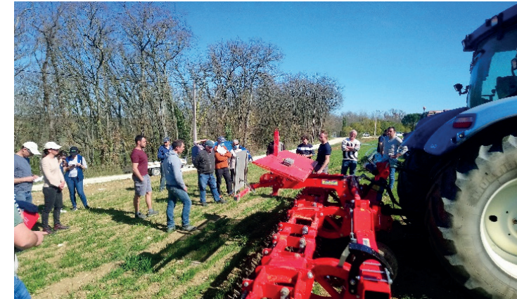
Modèle Einboeck avec réglage hydraulique de l'agressivité depuis 2014
