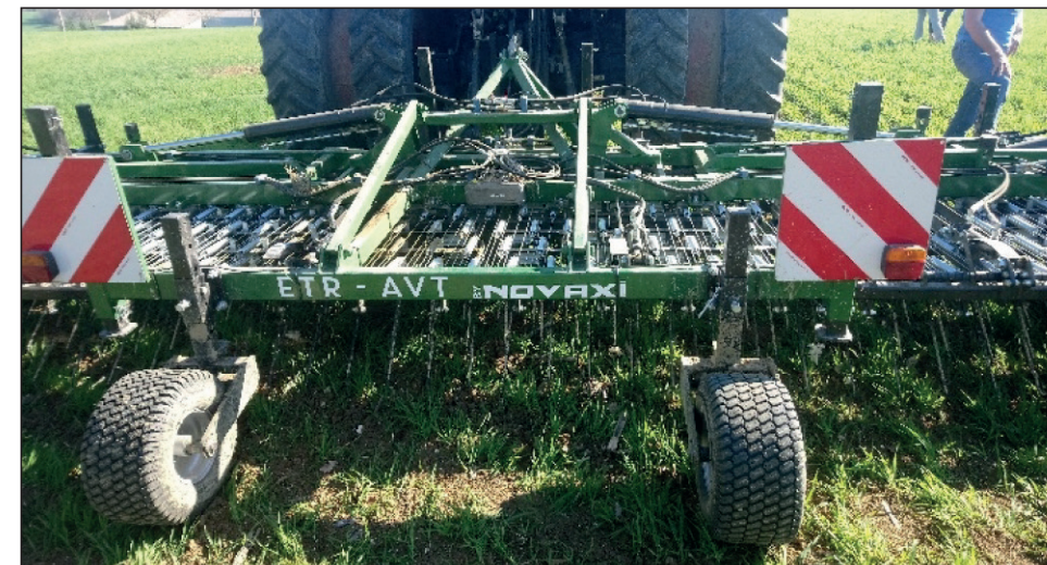
Marque ETR distribué par Novaxi, l'angle d'entrure de la dent est défini par commande hydraulique
