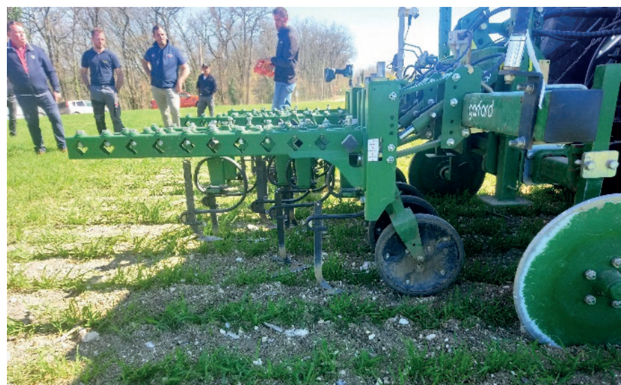
Le matériel anglais Garford : compact et agile, il dispose aussi d'une caméra colorimétrique, traitant 30 images par seconde.
