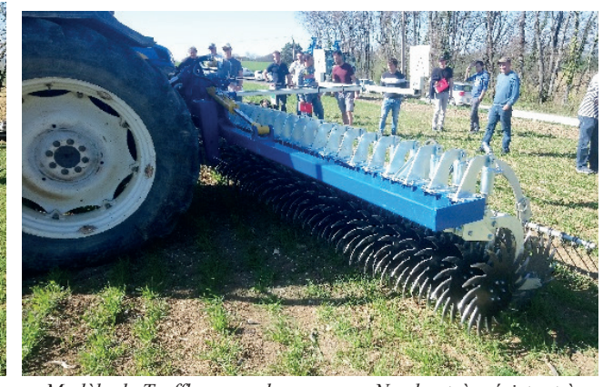
Modèle de Treffler avec des roues en Nardox très résistant à l'usure-prototype 2021, équipé d'une herse peigne
