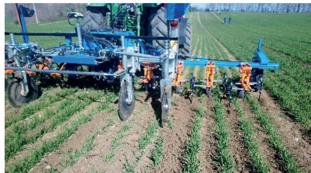
Le matériel avec bineuse allemande Schmotzer et un guidage Hollandais Raven double RTK tracteur plus bineuse : des disques arrière pilotés par la console RAVEN, alignent en permanence grâce au GPS RTK, le passage de la bineuse dans la trace virtuelle du semoir, lui-même aligné sur le tracteur.
