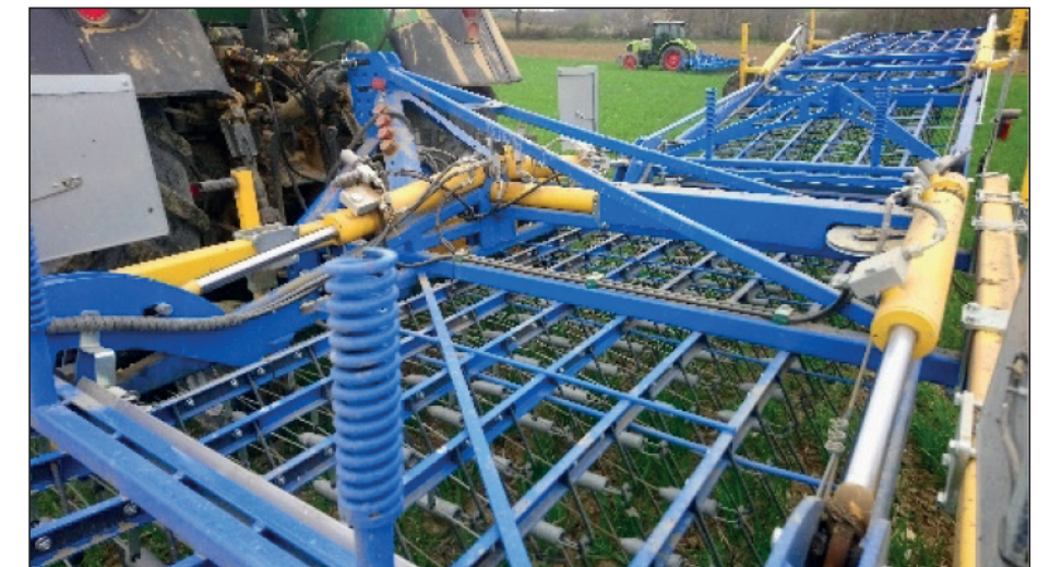
Sur le modèle de Treffler, les ressorts animant les dents sont situés sous le bâti, le principe de hauteur de réglage se fait par les roues avant et arrière
