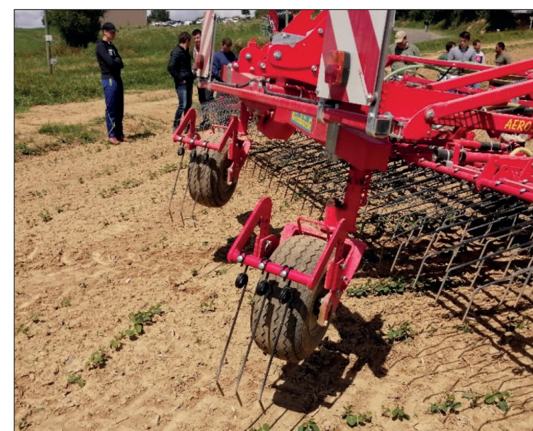
Herse étrille Einboeck modèle Exact, avec gestion de la hauteur des dents grâce à des roues arrière, l'agressivité se faisant par des vérins hydrauliques.
