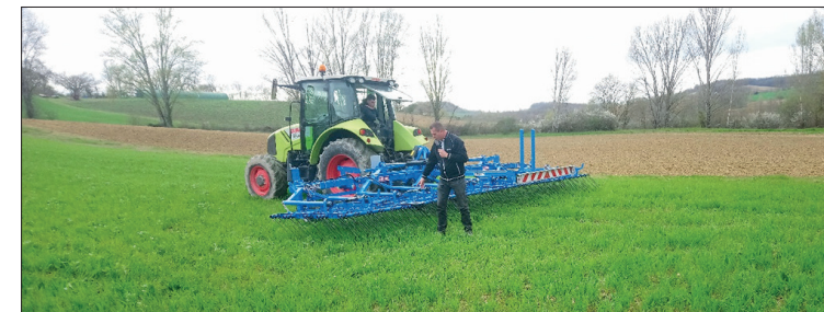
Herse Carré avec réglage hydraulique de l'agressivité
