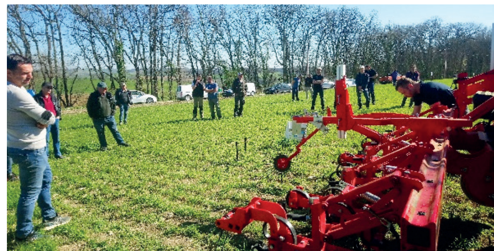
Le matériel autrichien EINBOECK : Bineuse plus caméra volumétrique, placée à l'arrière de la bineuse. Cette caméra distribuée par CLASS a repris un ancien modèle Class issu d'une caméra ECODAN initialement utilisée par STECKETE (aujourd'hui distribué par LEMKEN). Le traitement des images est propre à EINBOECK.
