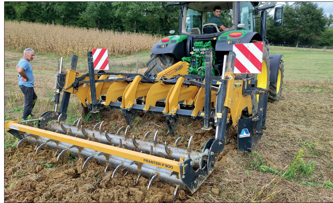
Fissurateur de sol en démonstration à Bars le 15 septembre.
