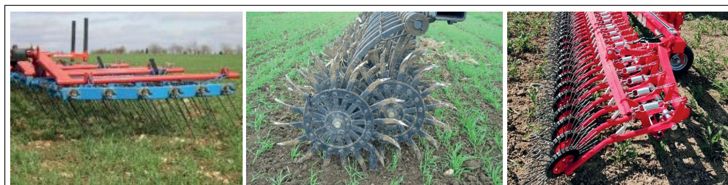
Les différents outils mécaniques : de la herse étrille, en passant par la houe rotative et suivi de la roto-étrille
