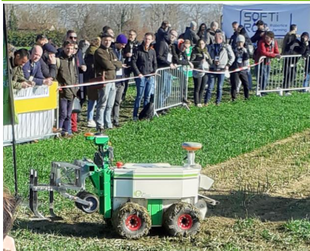
Le robot Oz en action (binage inter-rang)
