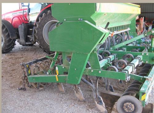
Le semoir à dents a été construit sur la base d'un châssis d'outil porté du type canadien. Une distribution pneumatique Accord a été ajoutée, ainsi que 6 roues qui assurent la régularité de la profondeur de semis. La fermeture des sillons est assurée par la forme étudiée des dents ainsi que par des chaînes à gros maillons, disposées à l'arrière du semoir.
