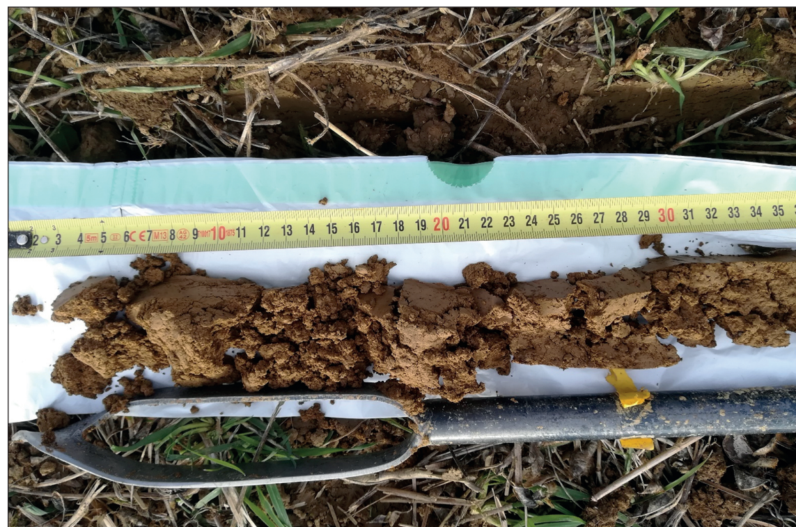
La réalisation du reliquat azoté sur une des 3 cultures principales de l'exploitation et avant tout apport d'engrais doit se réaliser sur au moins deux horizons (0-30 cm et 30-60 cm).
